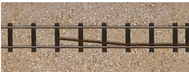
600mm Führungsschiene Anfang Kies (1) 600mm_BA1K_KK1
