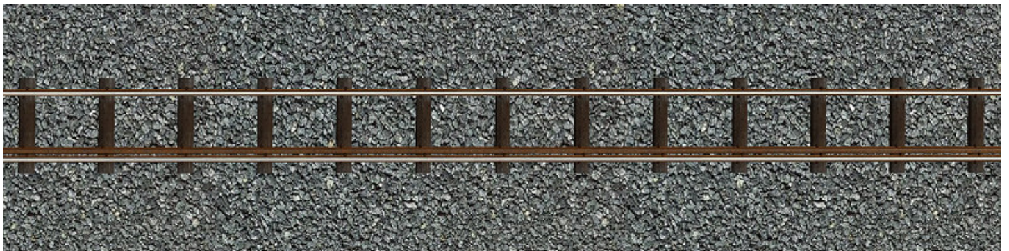
Gleis mit einer Führungsschiene und Schotterbett (ID 5334 – SO 20 cm)
