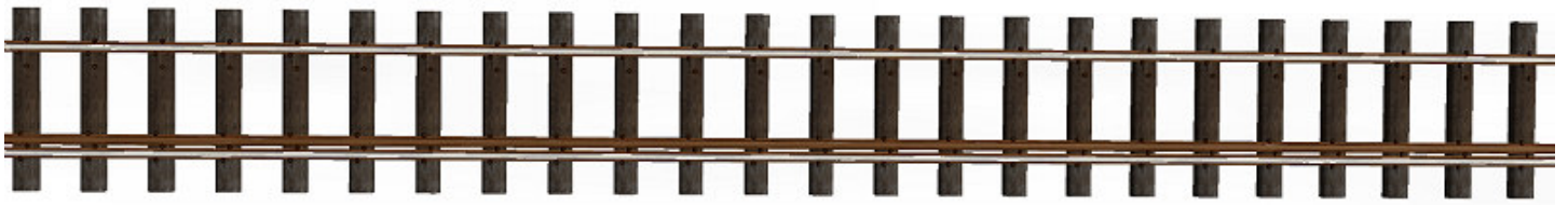
Brückengleis mit einer Führungsschiene (ID 5332 – SO 17 cm)
