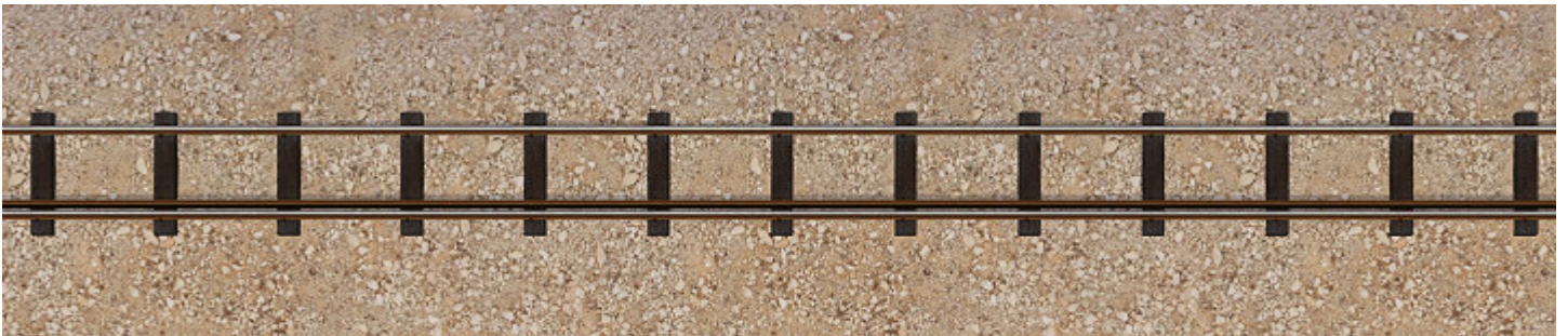
Gleis mit einer Führungsschiene auf Kiesbett (ID 5344 – SO 20 cm)
